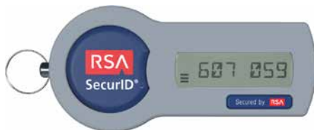
Obrázek 4.1: Potvrzovací kalkulátor RSA SecurID (autor obrázku Mgr. Rudolf Burda)
